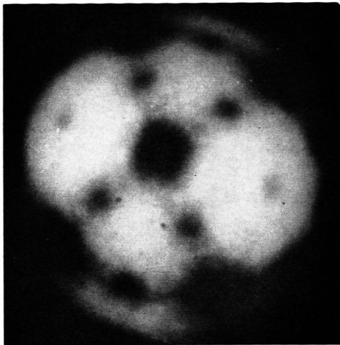
Abb. 1. Feldemissionsbild einer Wolframspitze nach dem Glühen (1 a) (saubere Spitze) und 27 Stunden später (1 b) (geringe Gasbedeckung).
